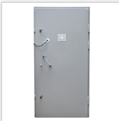
DRZWI WIĘZIENNE DONIMET DC3.1. ZK. Drzwi więzienne klasa C i RC4. Wymiar: dowolny. Konstrukcja: stalowa. Wypełnienie: wełna mineralna. Wyposażenie: 3 łożyskowane zawiasy, 3 blokady przeciwyważeniowe, pochwyt stalowy, łańcuch stalowy, zamek centralny rozporowy klasy 6, 2 zasuwki ręczne, wizjer typu więziennego ze szkłem kuloodpornym BR2. Wykończenie: lakierowanie proszkowe.
